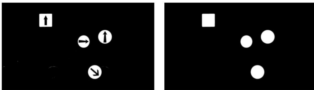
Obr. 5.2: Obrázok pred a po úprave morfológickými operáciami
