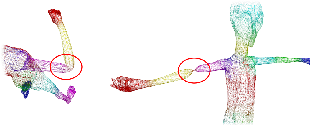
Obr. 11: Nedostatky súčasného prístupu: sploštenia (vľavo) a zaškrtenia (vpravo).
