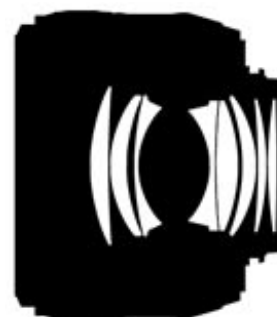
obr. 9 - optická stavba objektívu Nikkor AF-S 50mm f/1.4G [13]
