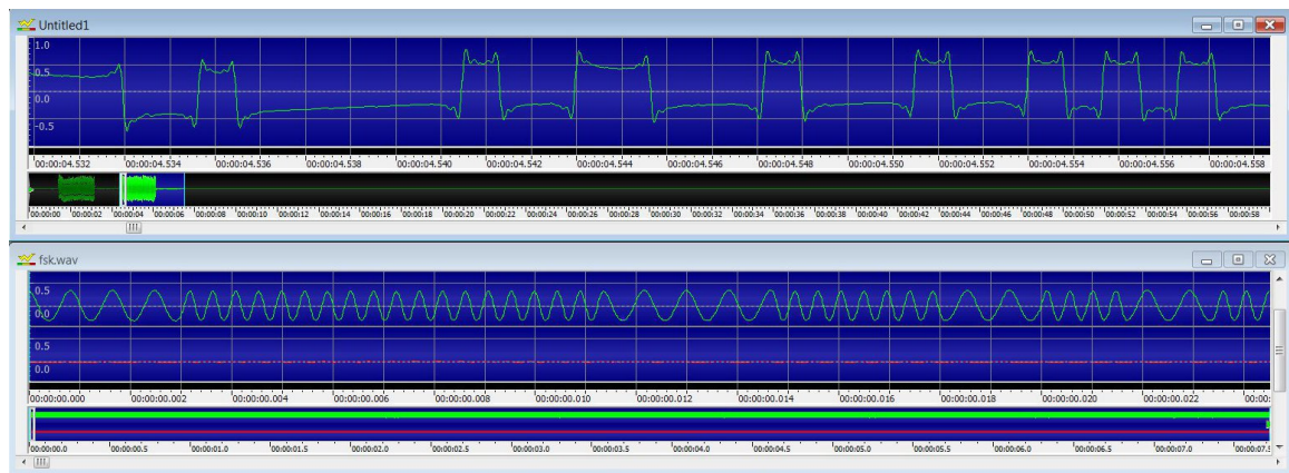
Obr. 1.1: Porovnanie Robots everywhere modulácie hore a klasickej FSK modulácie dole.
