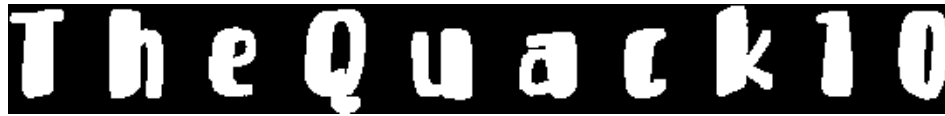
Obr. 2.4: Binárna matica prekreslená do obrazu, ktorú dostaneme po predspracovaní obrazu. Matica obsahuje dve slová.
