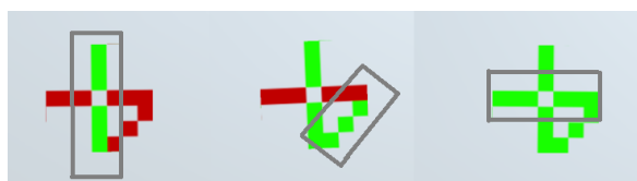
Obr. 3.4: Tu môžeme vidieť, čo reálne pásmo znamená. Pásmo sú hraničné hodnoty, cez ktoré nemôžeme prejsť, ak chceme korektné vykonať naše gesto.
