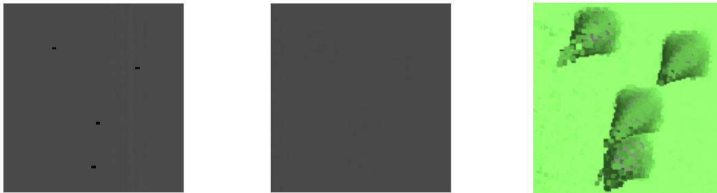
Obr. 3.8: Časť skenovanej scény obsahujúca nedefinované pixely vybraná zo vstupnej hĺbkovej mapy (vľavo), výstupnej hĺbkovej mapy filtrovania (v strede) a z nej vypočítaného mračna bodov (vpravo).
