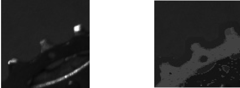
Obr. 3.6: Časť pôvodnej intenzitnej textúry obsahujúca lesk (vľavo) a upravenej intenzitnej textúry (vpravo), kde sa podarilo lesk do istej miery eliminovať.
