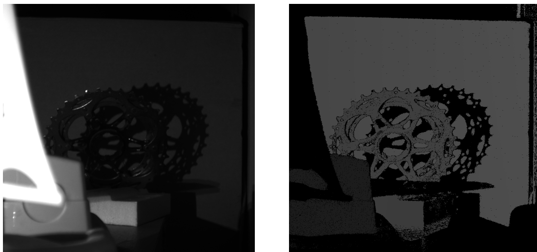
Obr. 1.1: Časť intenzitnej textúry (vľavo) a hĺbkovej mapy skenovanej scény zobrazenej ako 2D čiernobiely obraz (vpravo).
