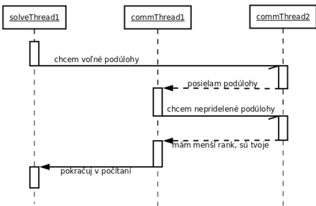
Obr. 3.3: Viac procesorov žiada o nepridelené podúlohy
