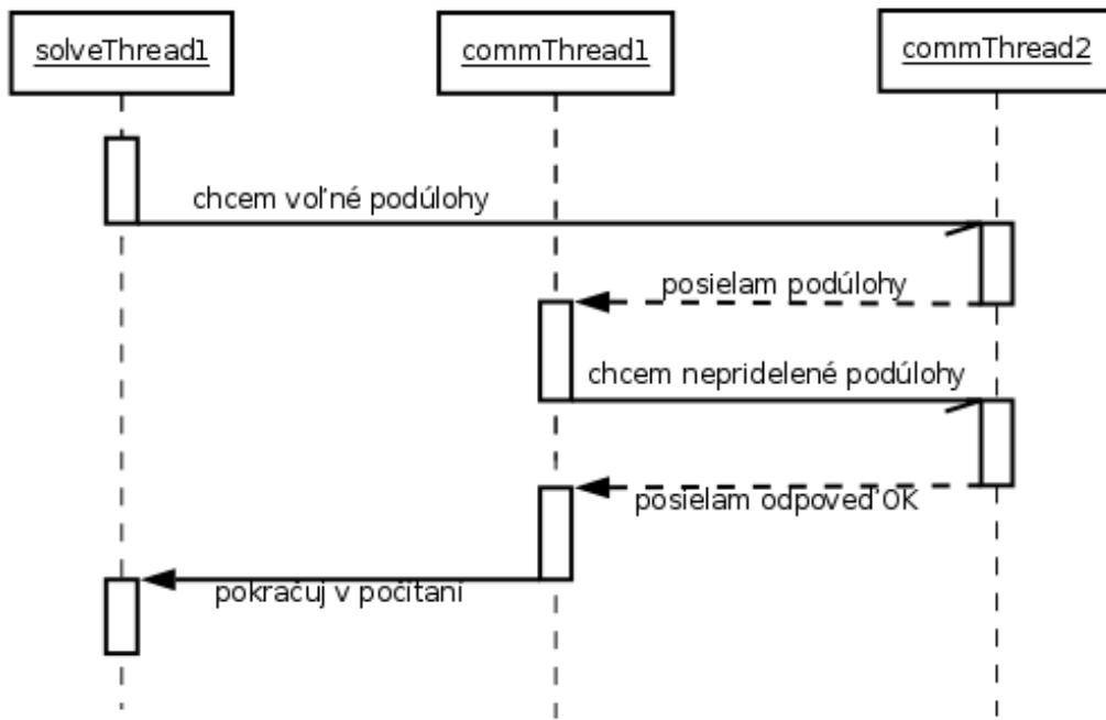
Obr. 3.2: Procesor chce nepridelené podúlohy
